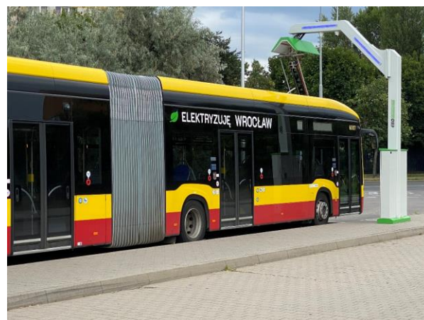
Rys. 4.9 Ładowanie autobusu elektrycznego akumulatorowego MEGA18 z ładowarki pantografowej we Wrocławiu
