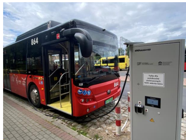
Rys. 4.7 Ładowanie autobusu elektrycznego akumulatorowego MAXI z terenowej ładowarki typu plug-in zlokalizowanej przy dworcu kolejowym w Jeleniej Górze
